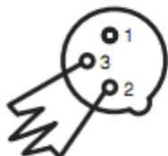
Терминатор уменьшает количество ошибок и позволяет избежать проблем при передаче сигнала и помех. Поэтому рекомендуется всегда использовать терминатор DMX (сопротивление  $120\Omega$ 1/4Вт между контактами 2 (DMX-) и 3 (DMX+) последнего устройства в цепи.
