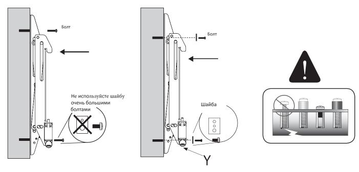
8. Аккуратно установите панели с установленными вертикальными креплениями на пластины (М) и заблокируйте замок (Y) простым нажатием. Порядок установки панелей смотрите на стр.6.
