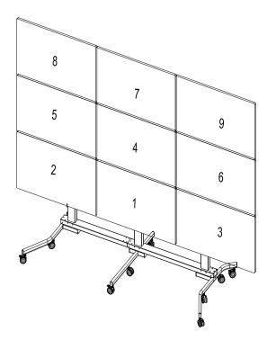
9. Данная стойка обладает функцией модульной системы, что позволяет увеличивать ширину видеостены (см. рисунок ниже). Добавляя элемент (L1) к стойке VWM363 мы получаем стойку VWM463. Добавляя элемент (L1) к стойке VWM463 мы получаем стойку VWM563.
