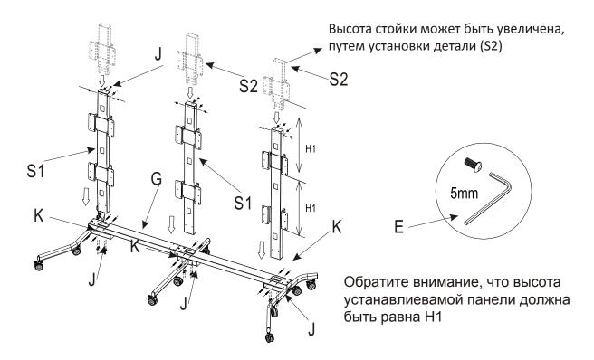
5. Установите пластины (M) на колонны (N) и затяните болты (L) отверткой (E1).
