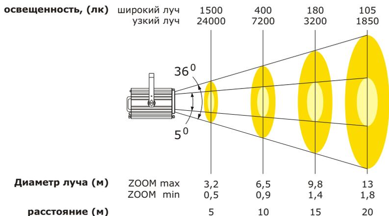
Испытания проводились с использованием лампы **CP/75 OSRAM 2000W 230V**
