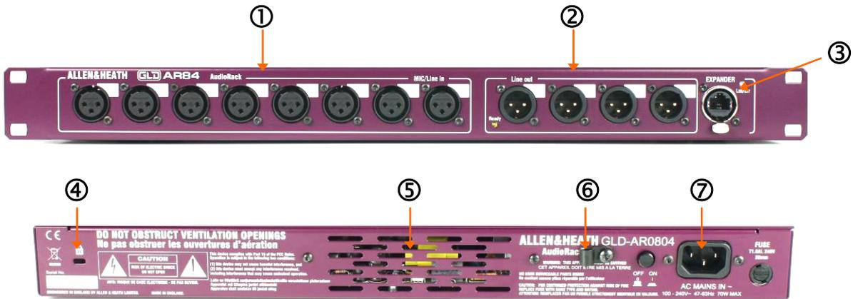
① **Входные разъемы** 8 балансных микрофонно/линейных XLR. Предусилители встроены в AR84 и их Gain,
