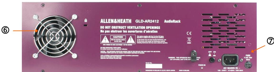
**⑥ Fan** Низкошумящий вентилятор обеспечивает приток воздуха в рэк и поддерживает рабочую температуру.
