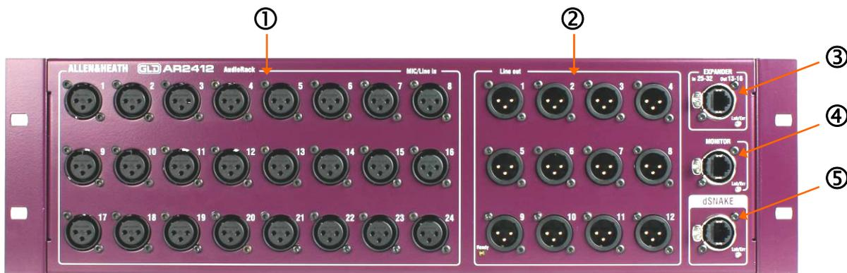
**① Входные разъемы** 24 балансных микрофонно/линейных XLR. Предусилители встроены в AR2412 и их Gain, Pad и фантомное питание 48В дистанционно контролируется консолью GLD через dSNAKE соединение. Выход аналоговых преампов конвертируется в цифровой формат и передается по dSNAKE для обработки и микширования в
